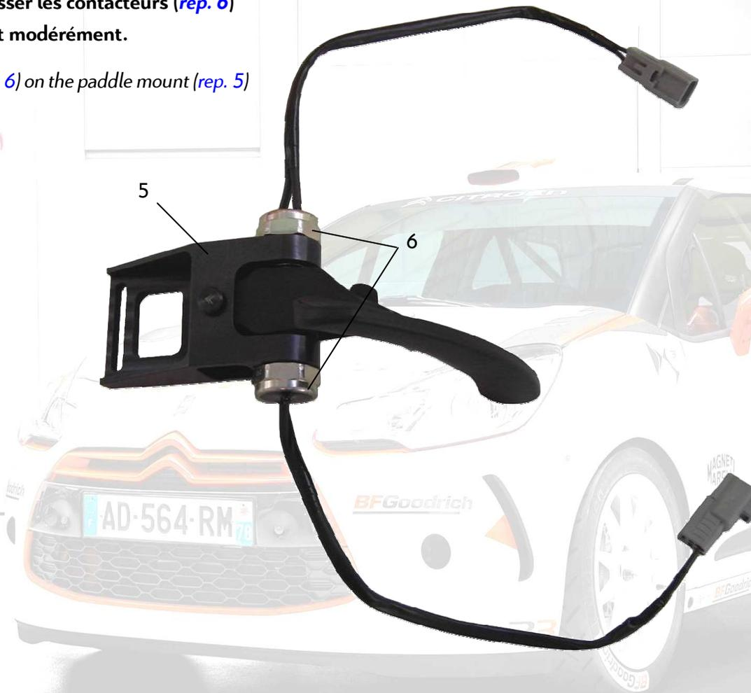
Assembler le Support de Palette sur la colonne de direction à l'aide des vis (rep. 8) et des rondelles (rep. 9) et positionner le bouton de verrou BV sur la Palette. Fixer le faisceau sur la palette à l'aide d'un rilsan (rep. A) et vérifier que le mouvement de la palette reste libre.
